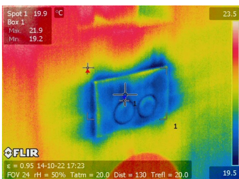
Slika 5 Loše izvođenje detalja zbog čega dolazi do infiltracije zraka u građevne dijelove zgrade
