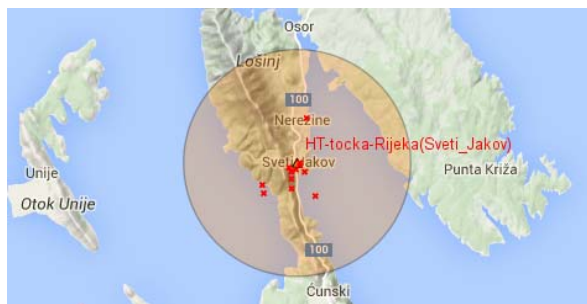
Slika 12. Atmosferska pražnjenja korelirana s kvarovima na izvodu
