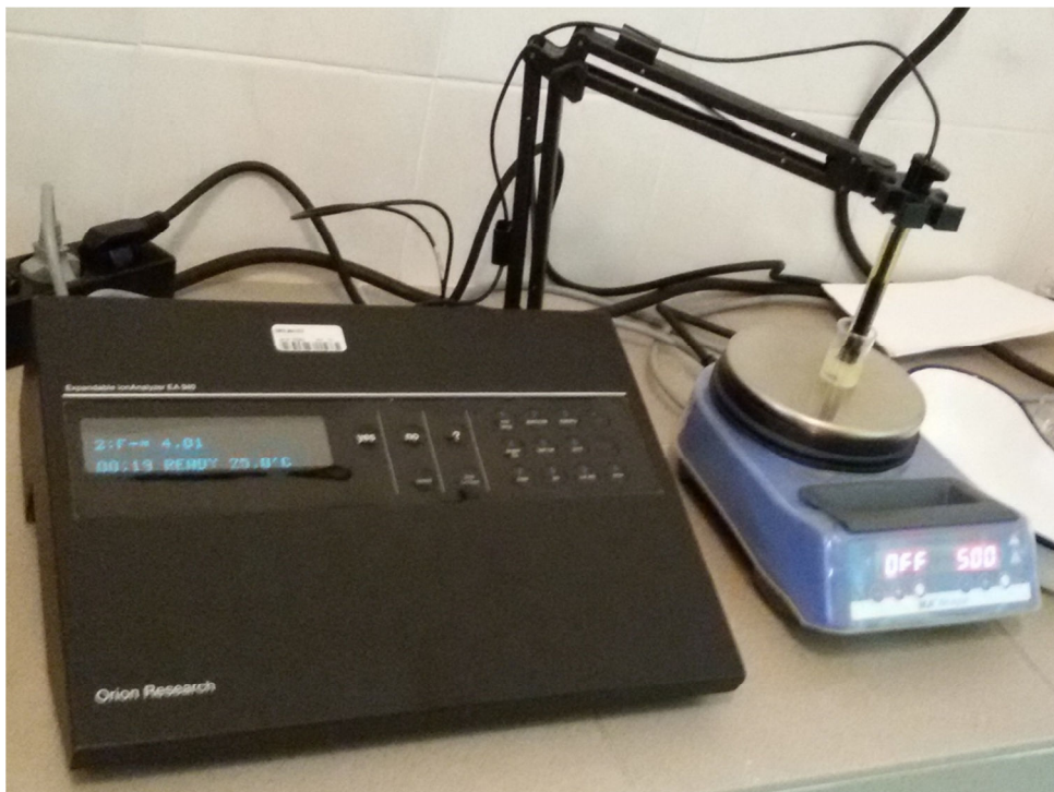
Slika 11. Ion selektivna elektroda Expandable Ion Analyzer EA 940 (Orion Research, Beverly, SAD) za određivanje količine fluoridnih iona u ispitivanoj otopini.
