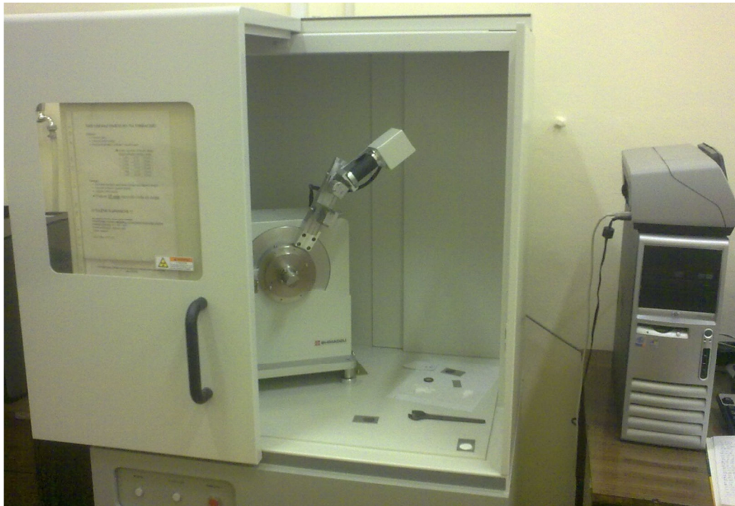
Slika 12. Uređaj XRD6000 sa \text{CuK}\alpha radijacijom (Shimadzu, Kjoto, Japan) za provođenje rendgenske difrakcijske analize (XRD).
