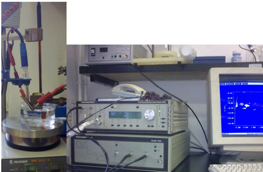
Slika 15. Troelektrodna ćelija (lijevo) spojena je na potenciostat Princeton Applied Research 263A (Ametek, Oak Ridge, SAD) i detektor frekvencije Princeton Applied Research 1025 (Ametek, Oak Ridge, SAD) (desno).
