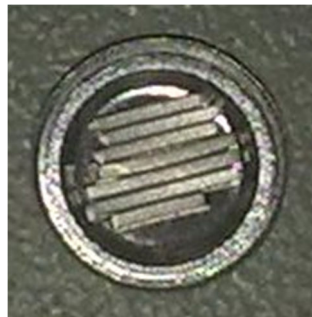
Slika 14. Uzorak žičanih lukova uloženi u aluminijske nosače za diferencijalnu pretražnu kalorimetriju (DSC).
