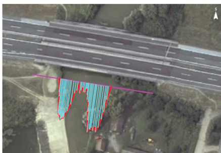
Slika 2. Promjena geometrije profila mosta u odnosu na projektno stanje (gore desno) i profil brzine kroz profil mostau postojećem stanju (dolje)
