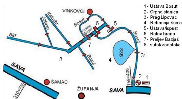
Slika 3: Shema hidrotehničkog sustava Pobošuća;
