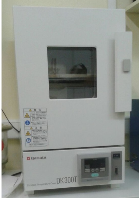
(a) Peć za predgrijavanje Yamato DK300T.
