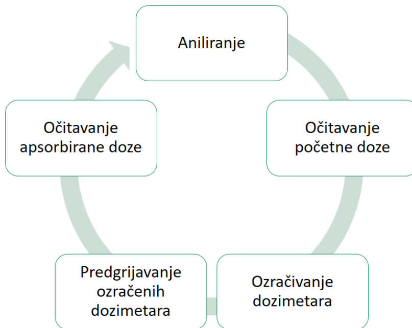
Slika 2.24: Ciklus korištenja RPL dozimetara za svako zračenje.
