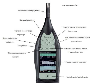
SI. 8. Zvukomjer tip 2250 Brüel & Kjaer.
