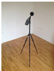
Sl. 10. Zvukomjer postavljen na pripadajući stalak s podešivom visinom.
