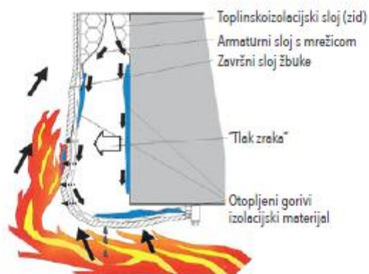
3. FAZA: - Pojava tlačnih naprezanja iza sloja vanjske žbuke (zbog toplog zraka i pirolitičkih plinova) - Oslobađanje pirolitičkih plinova kroz žbuku - Izgaranje organske žbuke - Izbočavanje i pucaње vanjskog sloja žbuke - Raspadanje ETICS sustava uz rub otvora pod težinom otopljene tvari - Stvaranje gorivih kapljica
