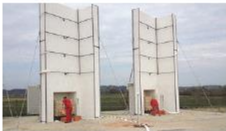
Paljenje konstrukcije od drvenih letvica – početak požara
