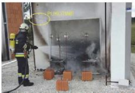
64 minute nakon početka – vatrogasci polijevaju M_3 zbog sigurnosnih razloga
