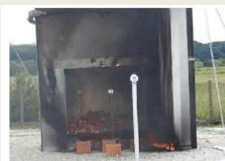
54 minute nakon početka – tinjanje uzorka EM_2
