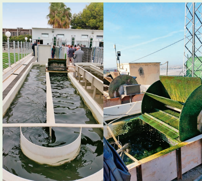
Slika 2. Bioreaktori otvorenog tipa (»raceway ponds«) u kojima se voda s hranjivim tvarima i suspendiranim mikroalgama pokreće uz pogon kotača s lopaticama. Pilot-postrojenje; Sveučilište u Almería, Španjolska.
