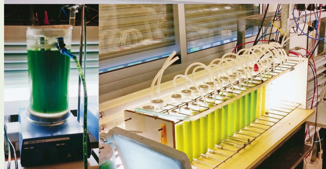
Slika 5. Izbor odgovarajućih vrsta mikroalgi i laboratorijsko testiranje. La Estación Experimental Cajamar Las Palmerillas, El Ejido, Almería, Španjolska.
