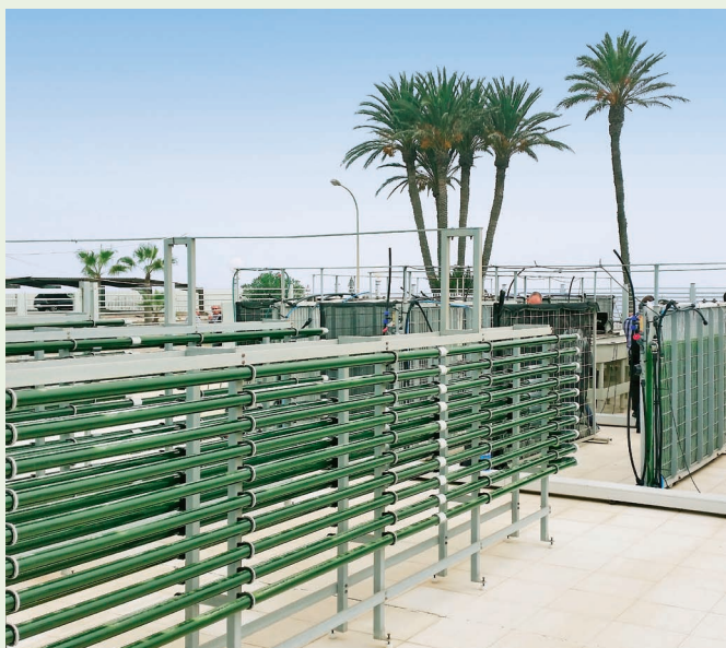
Slika 3. Zatvoreni fotobioreaktori u obliku vertikalno postavljenih cijevi i ravnih panela. Pilot-postrojenje; Sveučilište u Almerii, Španjolska.
