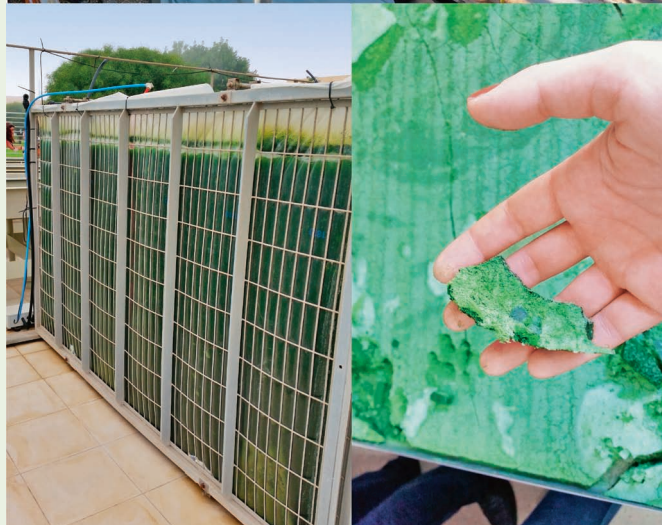
Slika 4. Fotobioreaktori u obliku horizontalno postavljenih cijevi, vertikalnih ravnih panela te liofilizirana biomasa mikroalgi. La Estación Experimental Cajamar Las Palmerillas, El Ejido, Almería, Španjolska.
