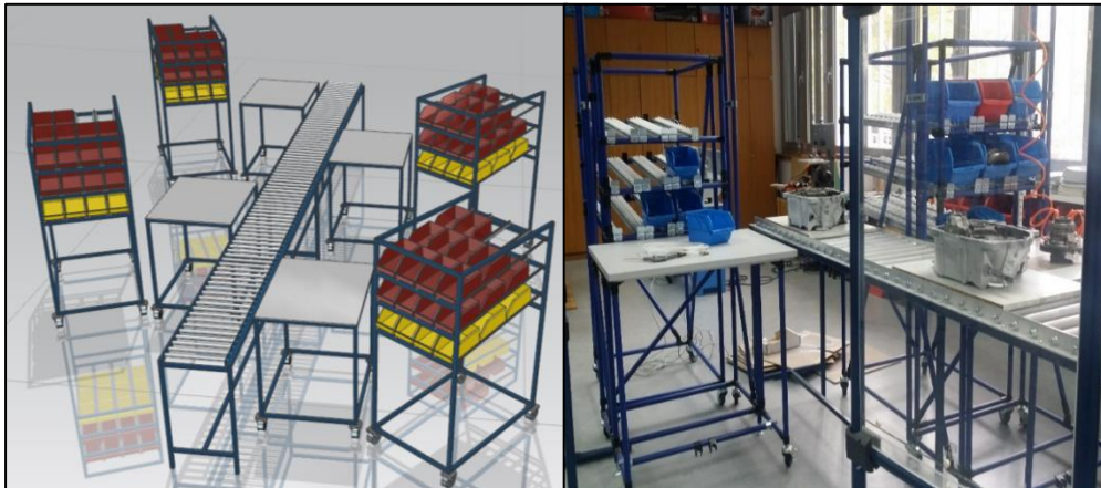
Slika 5 – 3D model i stvarni prikaz montažnog sustava
