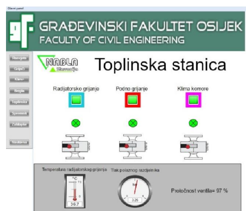
Slika 7. Podsustav CNUS-a za grijanje fakultetske zgrade
