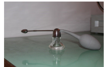
Slika 3.4: Atomizer za raspršivanje kapljica ulja.
