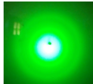
Slika 4.10: Pojavljivanje interferentnih prstenova zbog refleksije od dva seta ravnina u sloju grafita.
