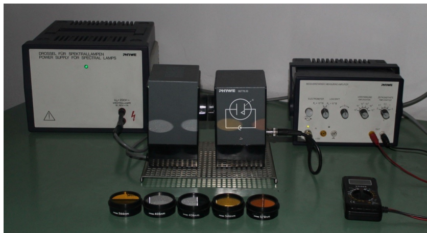
Slika 6.4: Eksperimentalni uređaj za mjerenje fotoefekta.
