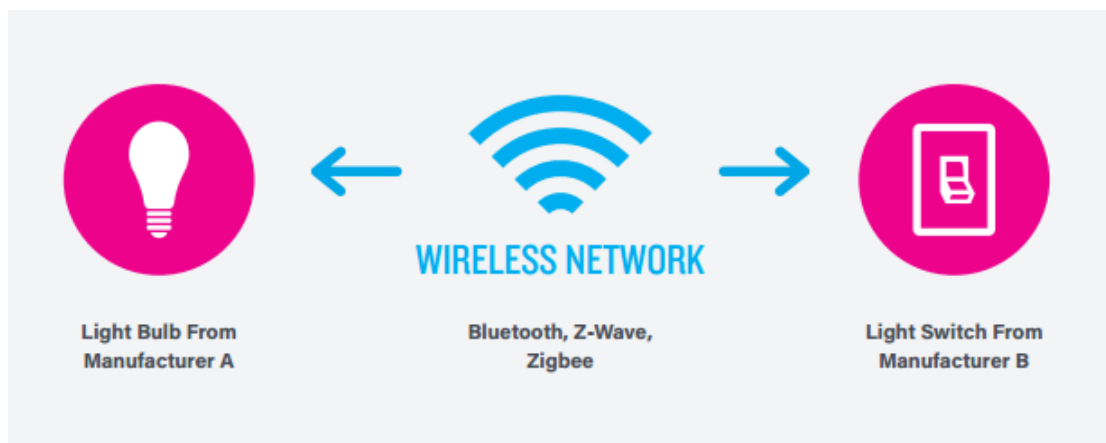
Slika 2. D2D komunikacijski model (Issack, 2017)
