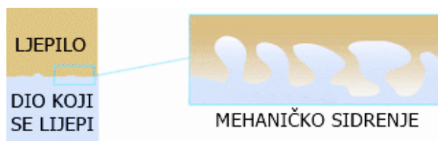
Slika 2. Prikaz mehaničkog sidrenja
