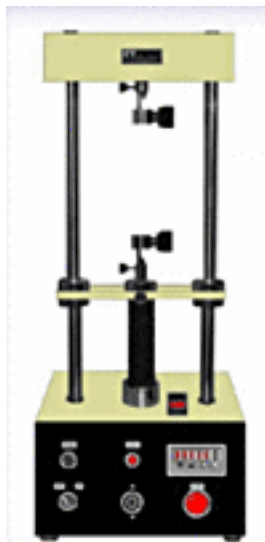
Slika 14. Uređaj za ispitivanje čvrstoće papira prema kidanju http://www.hellotrade.com/enrico-toniolo
