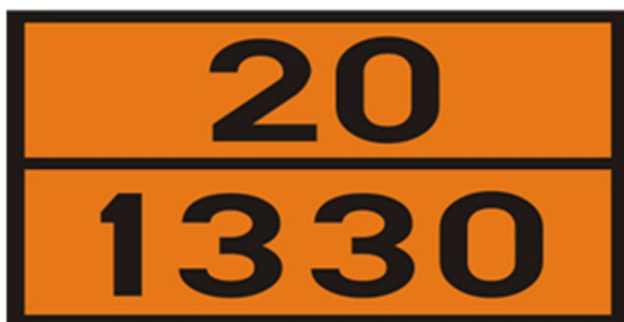
Slika 12. Pločica opasnosti prema ADR-u
