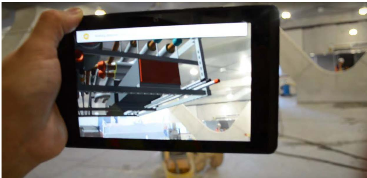
Slika 3. Primjer korištenja proširene stvarnosti na gradilištu (Shapetrace, 2016)
