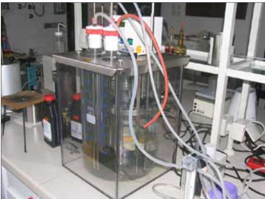
Slika 2. Aparatura za izvajanje testa penjenja, proizvajalec Petrotest
