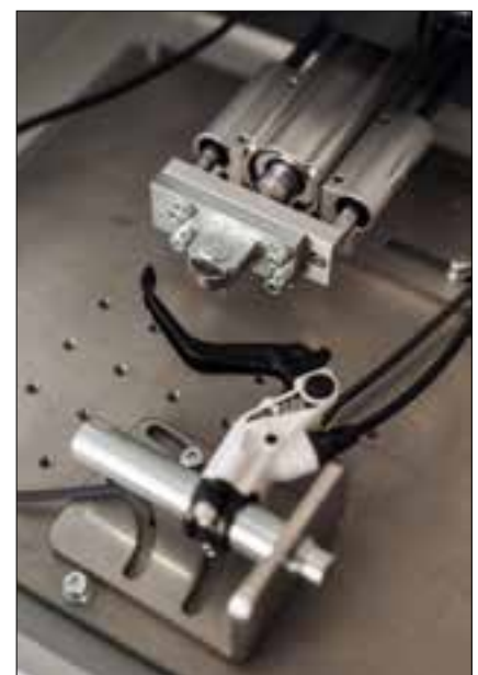
Slika 4. Linearni aktuator lahko pritiska na zavorno ročico s konstantno ali spremenljivo silo [1]
