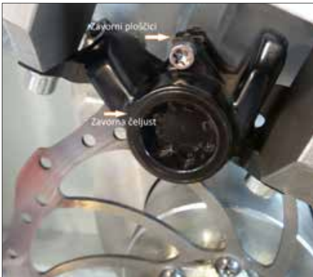
Slika 2. Zavorni sistem kolesa z diskom [1]
