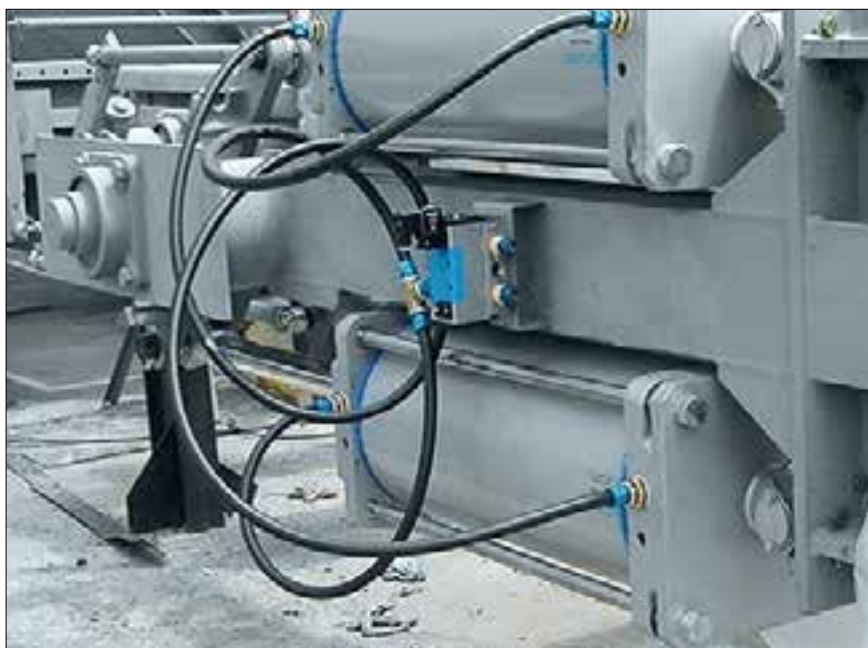
Slika 2. DSBG skrbi za optimalno dovajanje zraka z odpiranjem in zapiranjem loput in žaluzij
