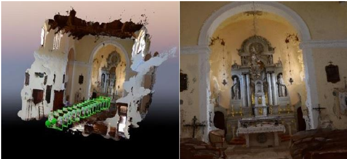
Slika 7.9: Teksturni 3D model unutrašnjosti: pozicije kamera (lijevo) i rekonstrukcija oltara (desno)
