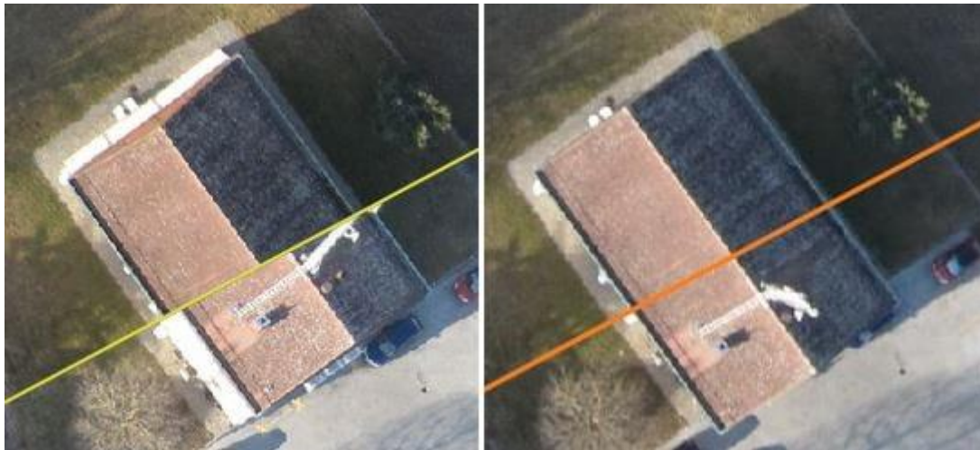
Slika 7.10: Spajanje fotografija (lijevo) i ortorektifikacija (desno) (URL 4)
