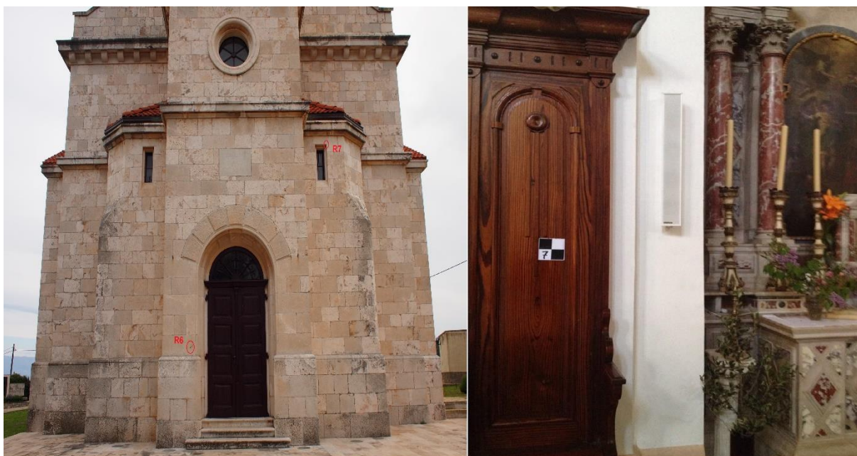
Slika 3.4: GCP izvan crkve označen crvenom bojom (lijevo) i GCP unutar crkve označen mjernom markicom (desno)
