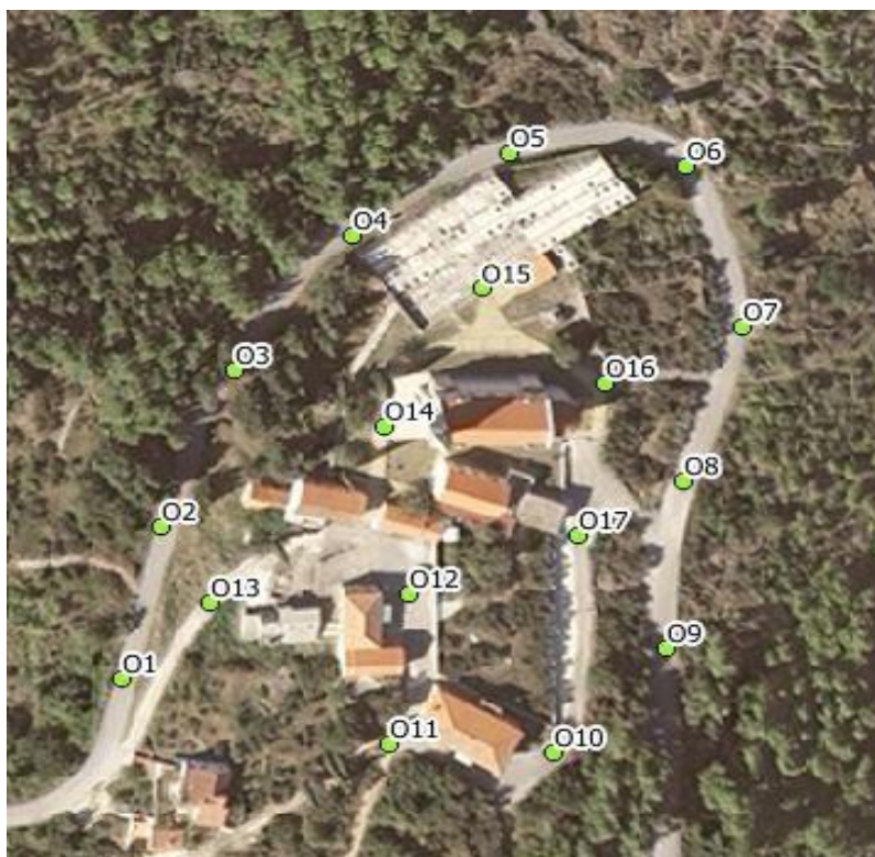
Slika 3.1: Plan orijentacijskih točaka za aerofotogrametriju (približno M 1:2 000)
