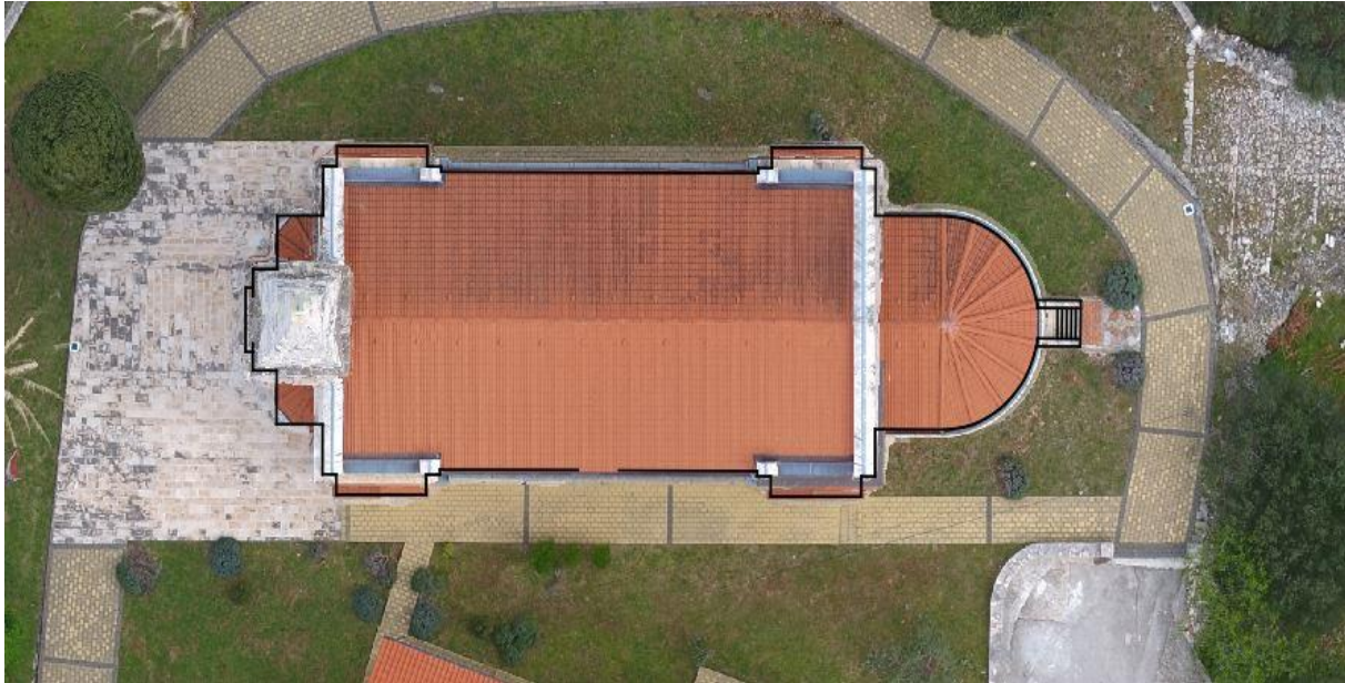
Slika 8.12: Usporedba ortofoto prikaza u odnosu na tlocrt crkve izrađen na temelju tahimetrijskih mjerenja (približno M 1:350)
