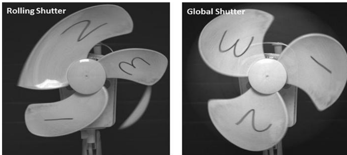
Slika 8: Slika iste scene snimana kamerom s kotrljajućim zatvaračem (lijevo) i globalnim (desno) (Andor)
