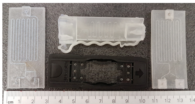
Slika 1 – Komercijalni stakleni mikroreaktor tvrtke Micronit te tri mikroreaktora izrađena aditivnim postupcima izrade
