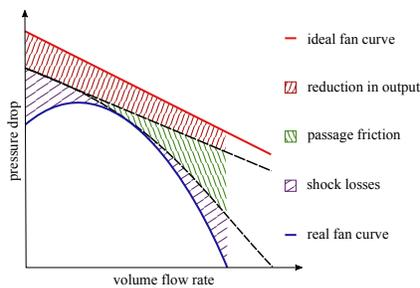
Fig. 2: Centrifugal fan losses
