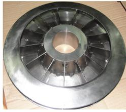
Fig. 10: Centrifugal fan prototype
