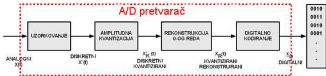
Slika 4. Shematski prikaz A/D konvertera (preuzeto iz http://laris.fesb.hr/digitalno_vodjenje/text_2-12.htm )
