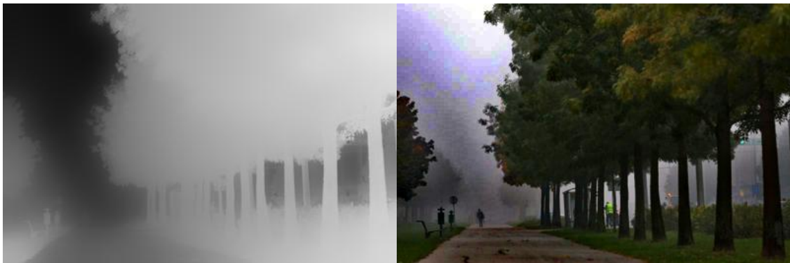
Slika 12. (a) Usavršena mapa prijenosa s \varepsilon = 0.01 (b) Slika bez izmaglice s \varepsilon = 0.01
