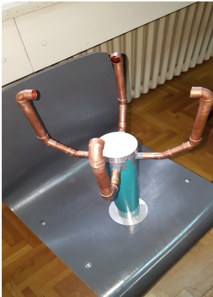
Slika 1.3 Konačan izgled konstrukcije, bez UZVS-ova
