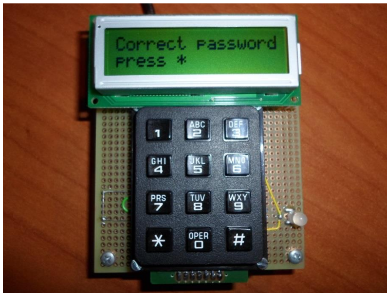
Slika 6.6 Prikaz reakcije LCD prikaznika na točnu lozinku
