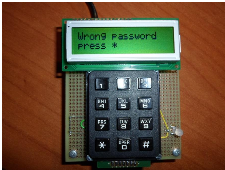
Slika 6.7 Prikaz reakcije LCD prikaznika na netočnu lozinku
