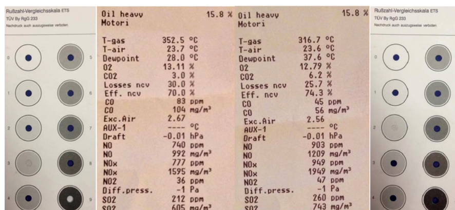
Figure 5 Exhaust emissions of IC engine at 50% (left) and 100% (right) load with smoke number Slika 5. Emisije ispuha IC stroja na 50% (lijevo) i 100% (desno) opterećenja s brojčanom oznakom
