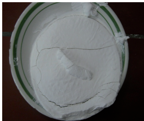
Slika 2. Osušeni talog \text{CaCO}_3 Solane prije tretiranja hidroseparacijom
