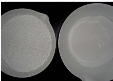
Slika 8. Pelet \text{CaCO}_3 ; granule prečnika 3mm,
