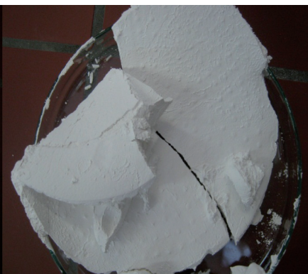
Slika 3. Osušeni talog \text{CaCO}_3 Sode sa primjesama prije tretiranja hidroseparacijom
