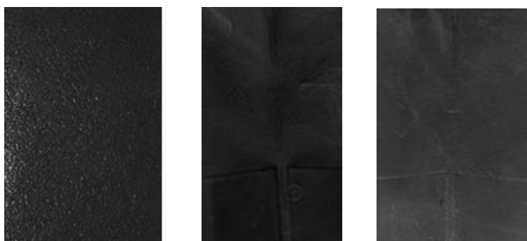
Slika 1: Uzorak GK1 a. prije ispitivanja, b. nakon 50000 ciklusa suhog savijanja, c. nakon 25000 ciklusa mokrog savijanja
