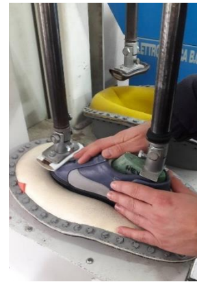
Slika 10: Učvršćivanje spoja gornjišta i đona pod prešom
