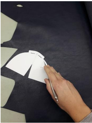
Slika 7: Označavanje šablona krojnih dijelova gornjišta cipel
