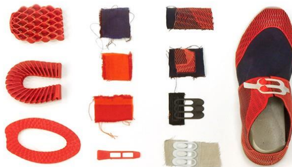
Slika 2: Primjer primjene taložnog očvršćivanja (FDM/FFF) u obućarstvu (izrada donjišta, 3D tiskanje na platnu, izrada kopči, i dr.) [4]
