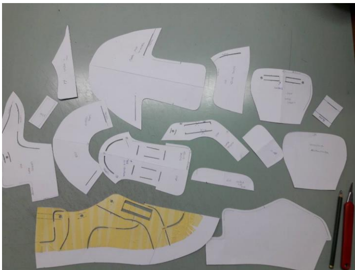
Slika 5: Šablone krojnih dijelova gornjišta cipela
