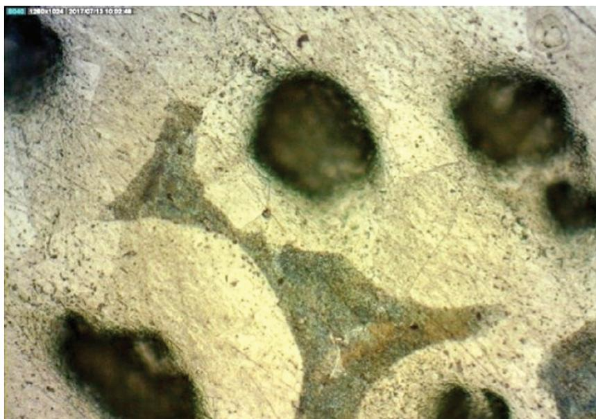
Figura 1 - Microstruttura iniziale dei campioni di ghisa duttile (200x) [11]
