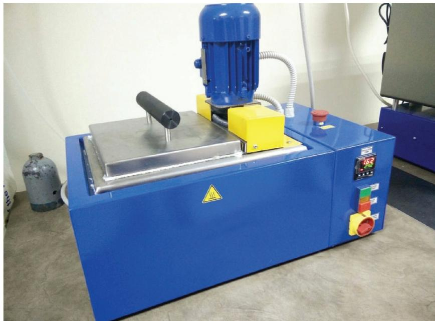
**Figura 3 - Dettaglio del forno a bagno di sale da laboratorio, utilizzato per il trattamento termico isoteramico**
