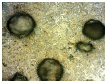
**Figura 5 - Microstruttura dopo austemperizzazione a 352 °C con agitazione del bagno di sale (200x)**
