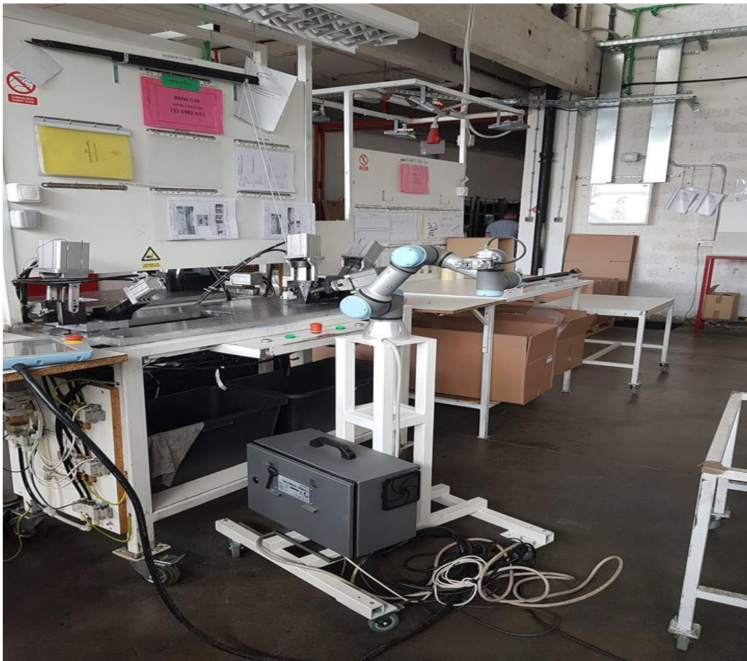
Slika 6.3. Universalov robot korišten za operaciju štancanja
