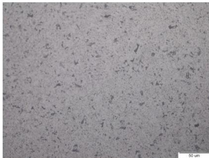
Slika 2.1 – Mikrostruktura aluminija (uzorak izložen temperaturi od 300°C)
