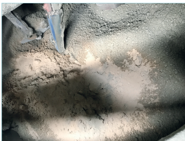
Slika 1: Dodavanje pepela u postupku miješanja betona za izradu šesterokutnih prizmi
