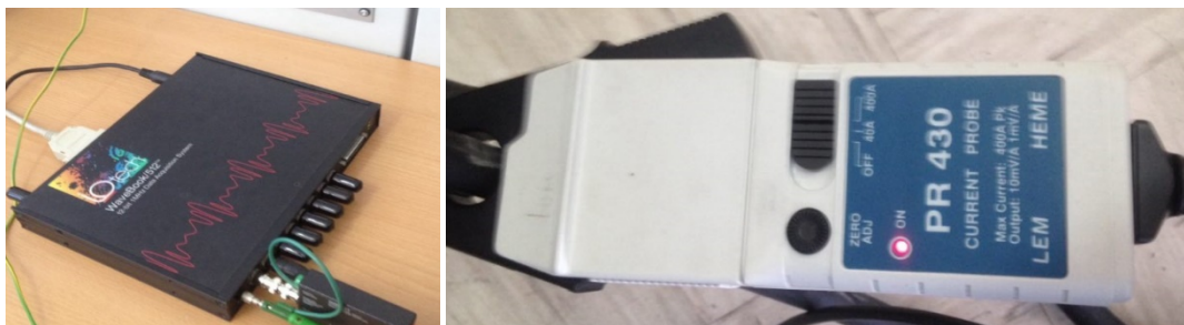
Slika 5. IOtech WaveBook 512 i strujna kliješta
