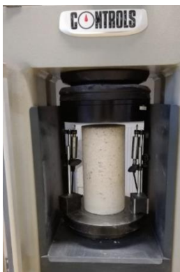
Slika 1. a) Postavke ispitivanja odnosa naprezanja i deformacije; b) Rezultati ispitivanja tlačne čvrstoće i modula elastičnosti na betonskim kockama.
