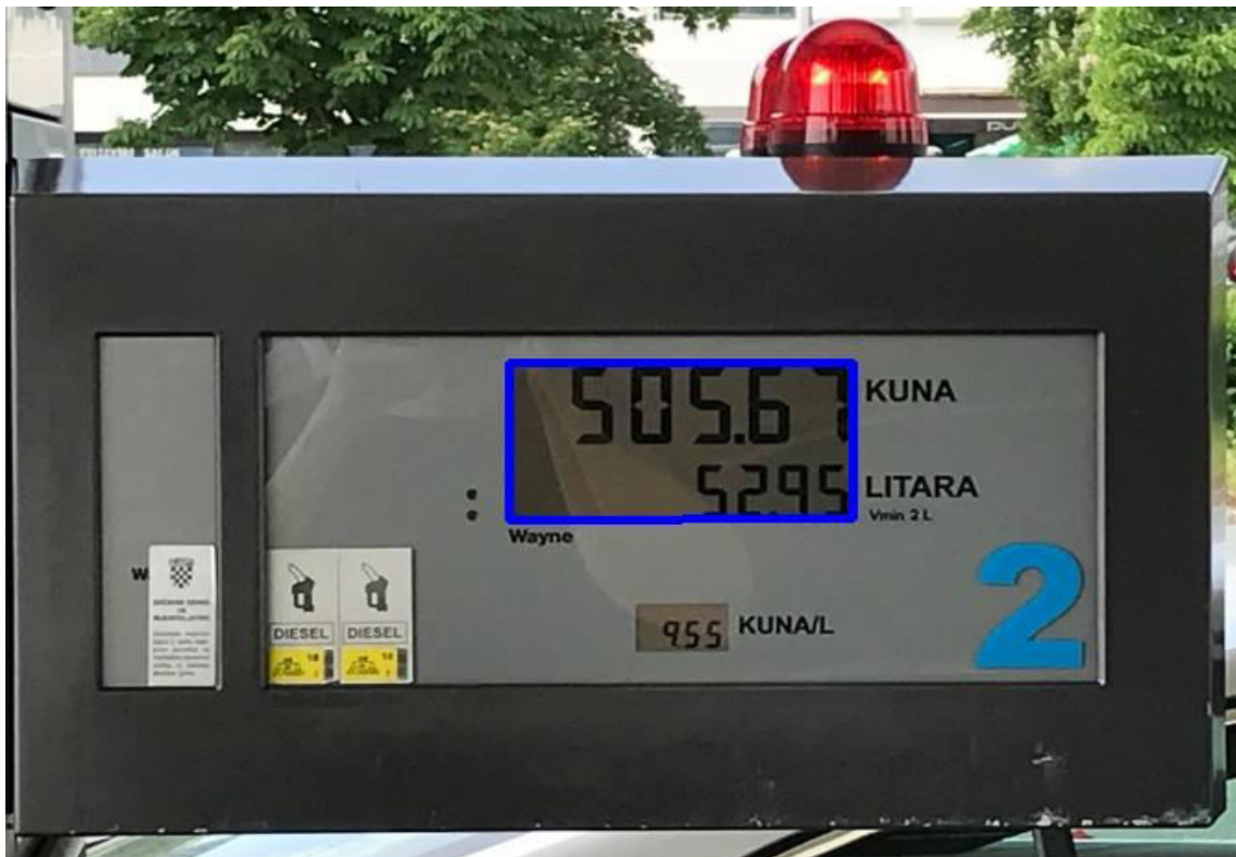
Slika 5.4 Istaknuta kontura detektiranog prikaznika
