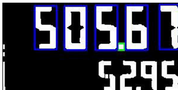
Slika 5.11 Rezultat algoritma segmentacije
