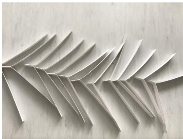
Slika 9.: Primjer izrezanog uzorka kartona GC1 u dimenzijama (135 x 15 mm)
