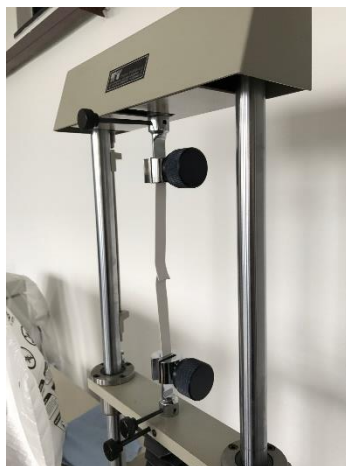
Slika 10.: Provođenje testa ljuštenja na kidalici.
