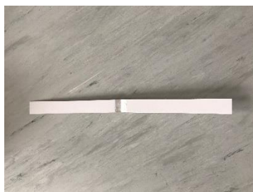
Slika 11.: Prikaz uzorka nakon provedenog testa ljuštenja
