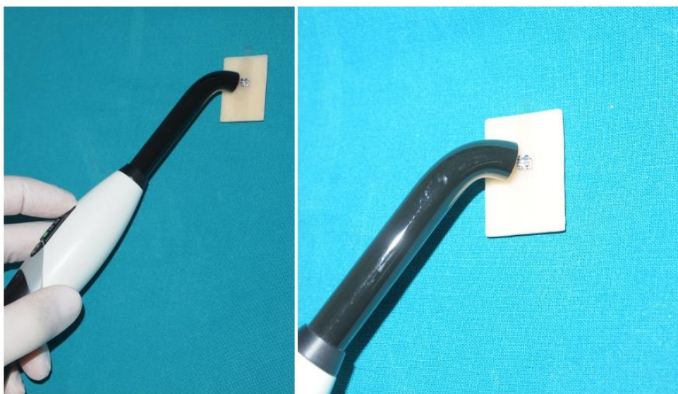
Slika 8. Položaj lampe neposredno prije osvjetľjavanja uzoraka.
