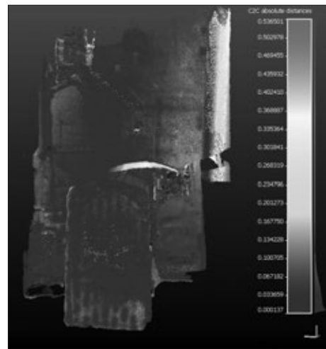
Slika 5: Pojava vitoperenja do koje je dolazilo prilikom mobilnog skeniranja
