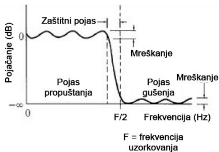
Slika 2.4 Frekvencijska karakteristika praktično izvedenog anti-aliasing filtra.
