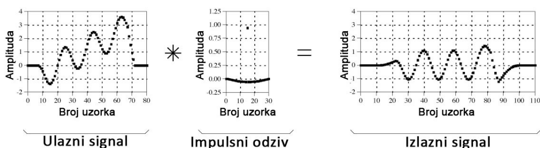
Slika 6.10 Primjer uporabe konvolucije kod filtriranja signala.
