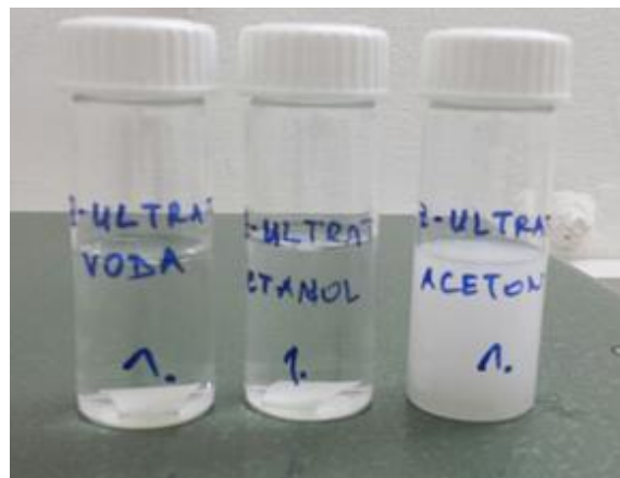
Slika 13. Ponašanje materijala Z-ULTRAT u sva tri otapala
