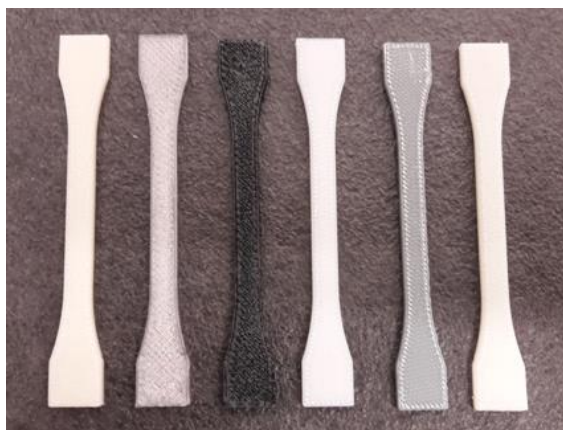
Slika 3. Ispitne epruvete izrađene na FDM pisaču
