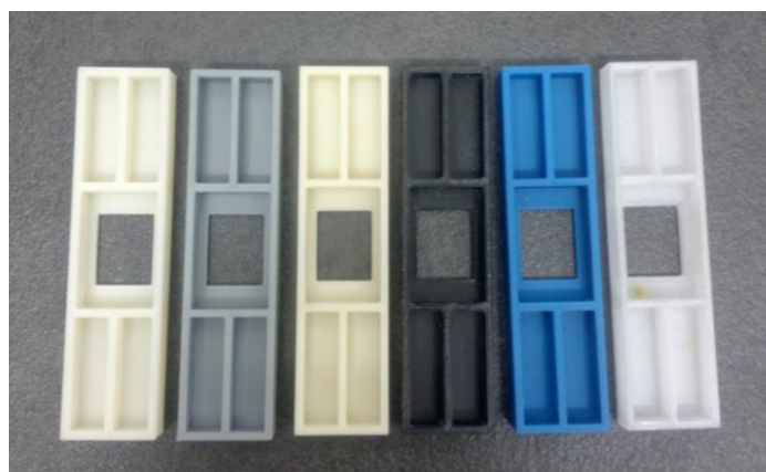
Slika 9. Referentni modeli nakon tiskanja (korišteni materijali s lijeva na desno su: Z-ULTRAT, Z-HIPS, Z-PCABS, Z-PETG, Z-ABS, Z-GLASS)
