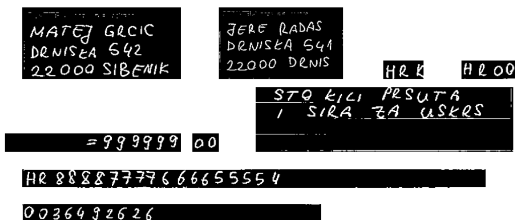
Slika 28. Ekstrahirana polja uplatnice uz primjenu Otsuove metode
