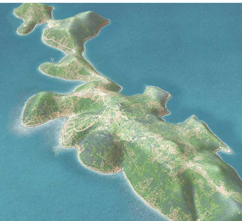
Slika 9. Vizualizacija otoka Rave dobivena preklapanjem ortofotoslike Rave s DMR-om istog područja
