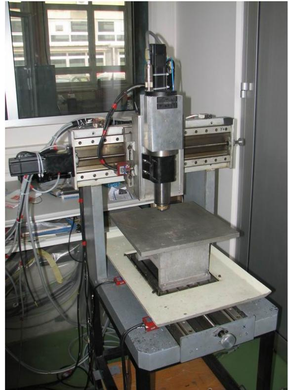
Figure 6. 3-axis mini milling machine
