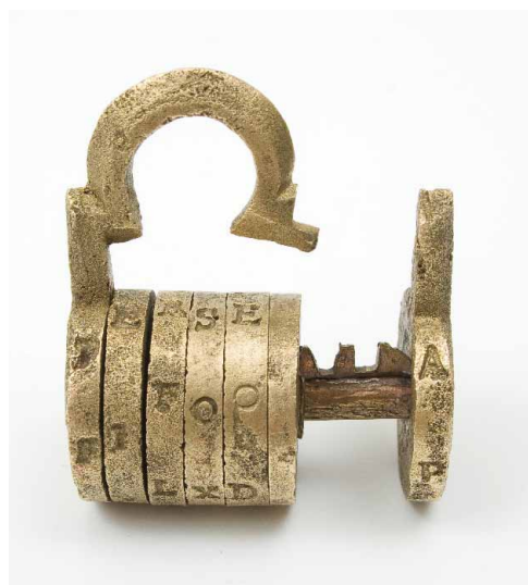
sl.9. Mjedeni katanac s mehanizmom na kombinaciju (foto: R. Mosković)
